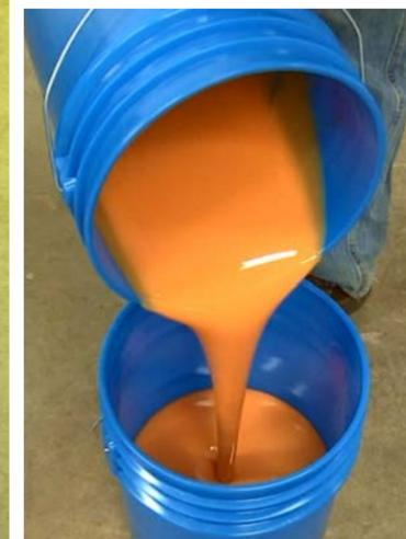
**3** El PMC®-780 es pigmentado y mezclado mecánicamente.
