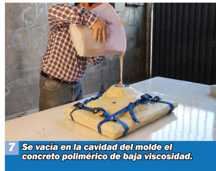
7 Se vacía en la cavidad del molde el concreto polimérico de baja viscosidad.
