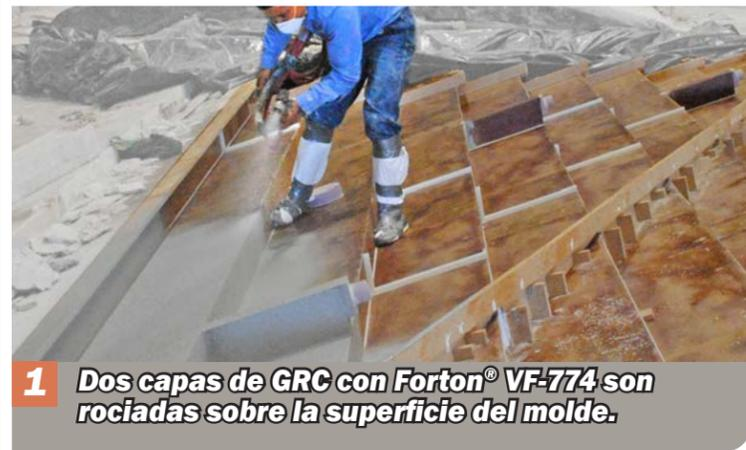
**1** Dos capas de GRC con Forton® VF-774 son rociadas sobre la superficie del molde.
