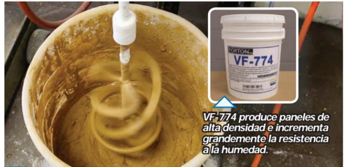
**5** Los componentes del GRC son mezclados en una mezcladora de alto cizallamiento.
