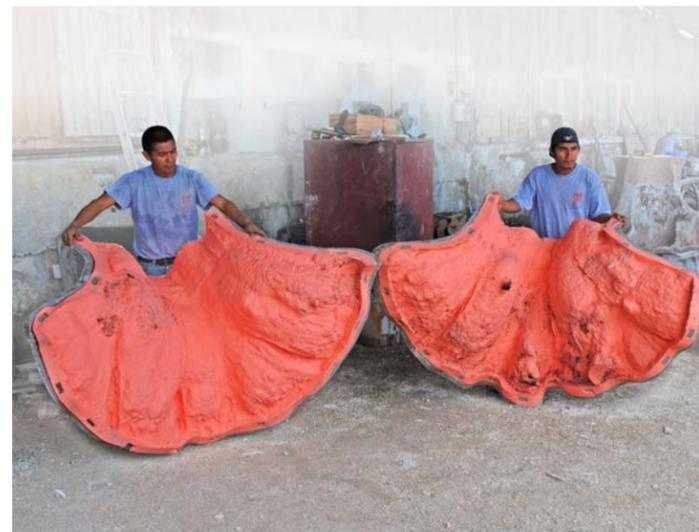
**4** Se fabrica un contramolde. El caucho es removido del original y está listo para GRC.
