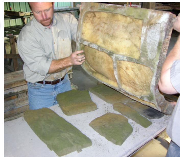
**5** La piedra es desmoldada e inspeccionada para garantizar la calidad.
