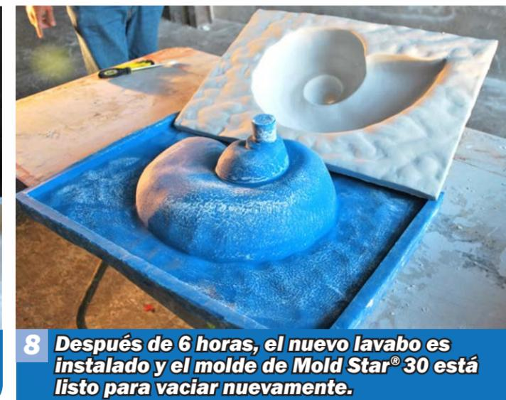
8 Después de 6 horas, el nuevo lavabo es instalado y el molde de Mold Star® 30 está listo para vaciar nuevamente.
