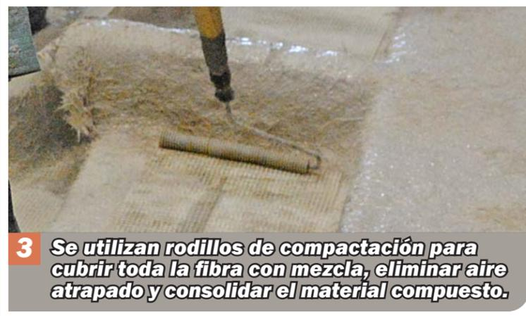
**3** Se utilizan rodillos de compactación para cubrir toda la fibra con mezcla, eliminar aire atrapado y consolidar el material compuesto.
