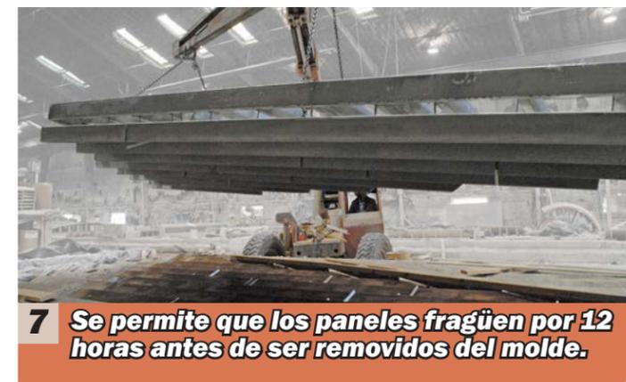
**7** Se permite que los paneles fragüen por 12 horas antes de ser removidos del molde.
