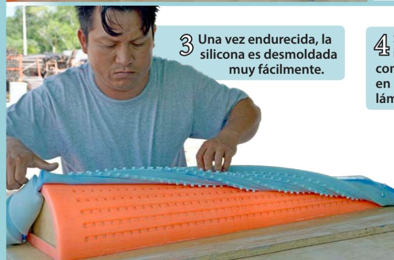
4 Se eligió Smooth-Sil® 935 por su resistencia al ataque químico del concreto polimérico utilizado en la producción de estas lámparas de pared.
