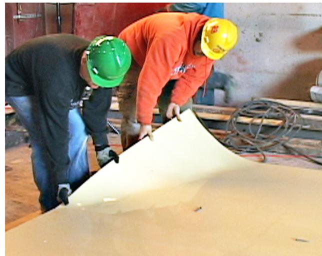
**2** Se permite que el caucho endurezca y luego se desmolda.
