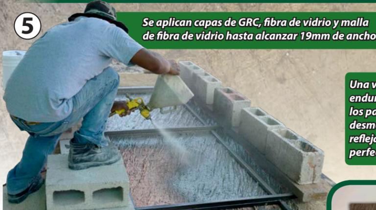
5 Se aplican capas de GRC, fibra de vidrio y malla de fibra de vidrio hasta alcanzar 19mm de ancho.
