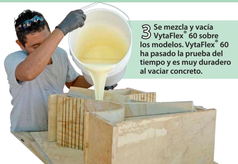
3 Se mezcla y vacía VytaFlex® 60 sobre los modelos. VytaFlex® 60 ha pasado la prueba del tiempo y es muy duradero al vaciar concreto.
