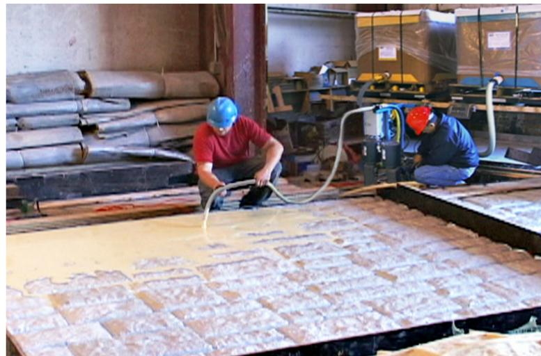
**1** El caucho VytaFlex® 60 es vaciado con la máquina EZ MIX METER MIX.
