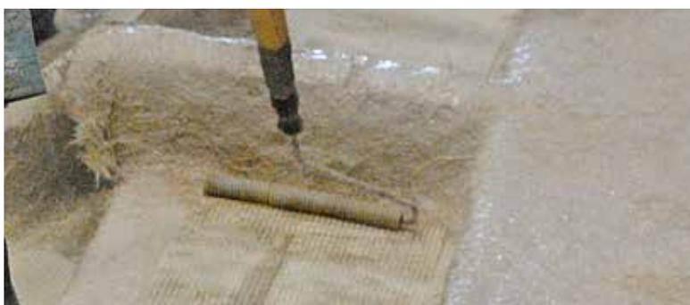
**3** Se utilizan rodillos de compactación para cubrir toda la fibra con mezcla, eliminar aire atrapado y consolidar el material compuesto.
