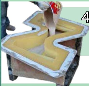
5 Se instalaron los vaciados para crear paredes de celosías de más de 150 m<sup>2</sup>.
