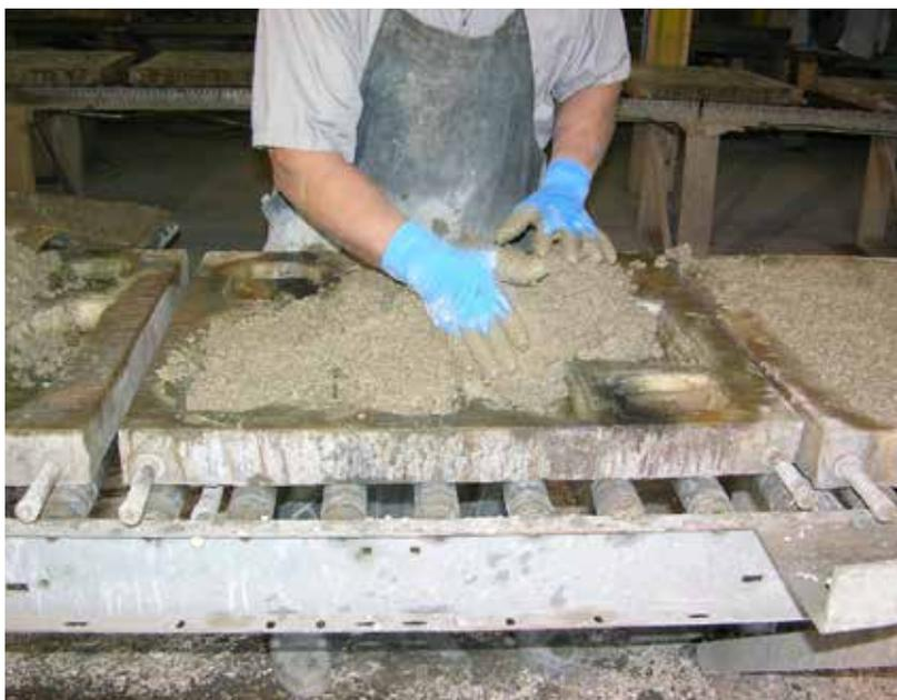
**3** El concreto es vaciado en el molde.
