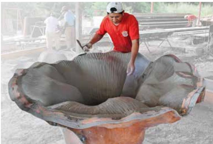
**6** Se aplica una malla de fibra de vidrio y GRC adicional a mano para incorporar la unión.
