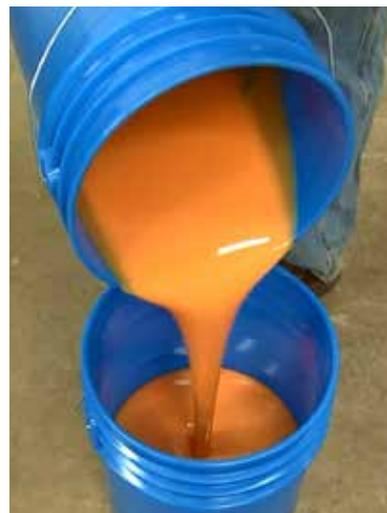
**3** El PMG®-780 es pigmentado y mezclado mecánicamente.
