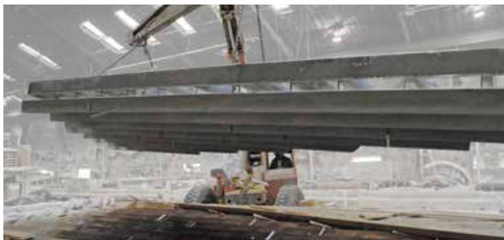
**7** Se permite que los paneles fragüen por 12 horas antes de ser removidos del molde.
