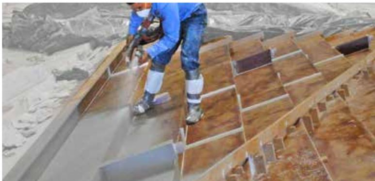
**1** Se rocían dos capas de GRC con Forton® VF-774 sobre la superficie del molde.
