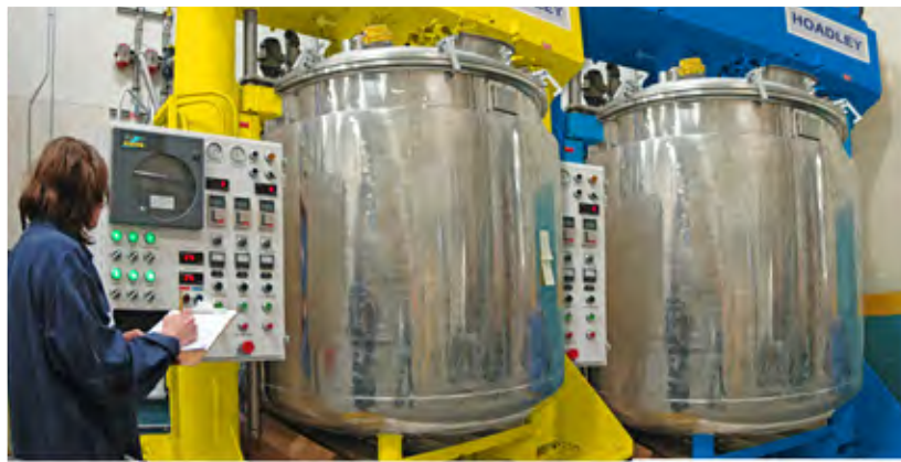
La fábrica de Smooth-On alberga dos de los recipientes de mezcla de silicona más grandes de Norteamérica (1,500 galones / 5,678 litros), cada uno impulsado por 3 motores de 100 caballos de potencia y palas mezcladoras de alto cizallamiento.
